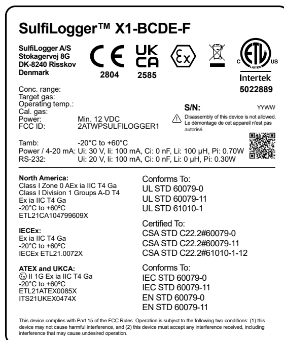
Fig. 4 Exemple de plaque de marquage (PowerCom Box)
