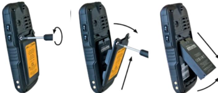
» Afloje los tornillos del compartimento de la batería con el Destornillador suministrado.
