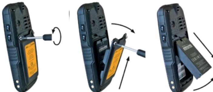
» Odkręcić śruby na komorze baterii za pomocą dołączonego śrubokręta.
