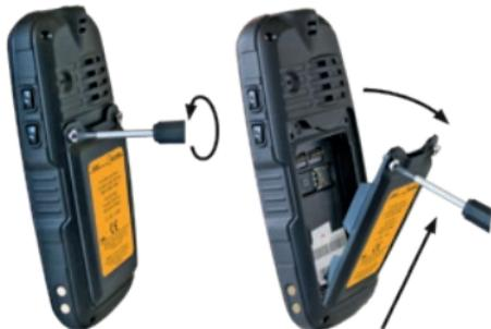
» バッテリーソケットのネジを付属のドライバーでゆるめます。
