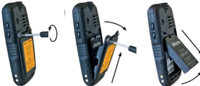
» Lossa skruvarna vid batteriutrymmet med den medlevererade skravmejseln.
