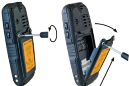
» Avaa akkukotelon ruuvit toimitukseen sisältyväällä ruuvitallalla.
