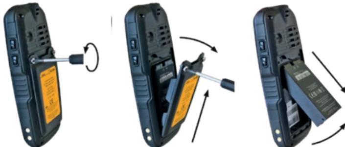
» Otpustite vijke na pretincu za bateriju isporučenim odvijačem.
