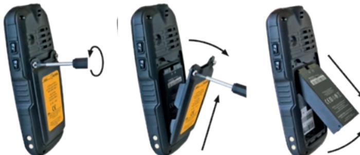
» Draai met de meegeleverde schroevendraaier de schroeven van het accucompartment los.
