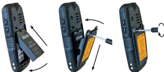
» バッテリーは図のようにバッテリーソケットに取り付けます。
