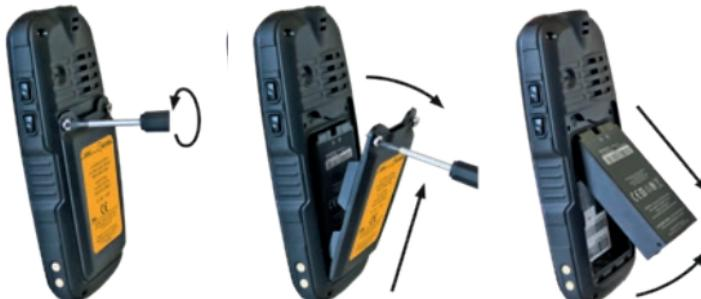
» Desserrez les vis du compartiment de la batterie à l'aide du Tournevis fourni.
