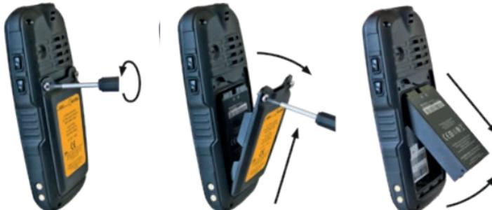
» Svitare le viti del vano batteria con l'apposito cacciavite in dotazione.
