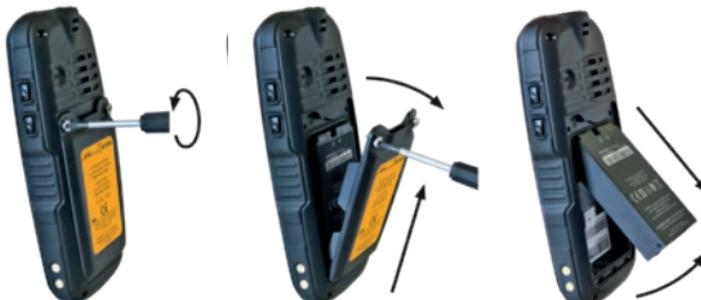
» Solte os parafusos no compartimento de bateria com a chave de fenda fornecida.
