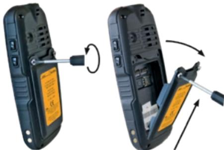
» Svitare le viti del vano batteria con l'apposito cacciavite in dotazione.
