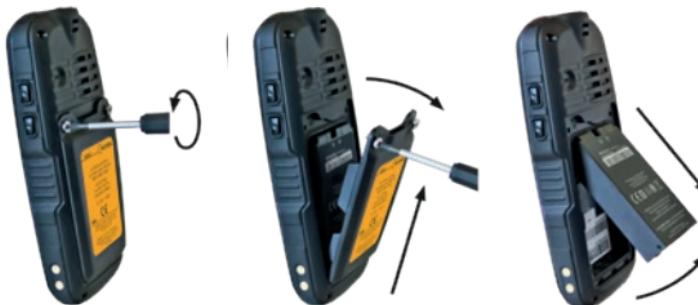
» Ослабьте винты на отсеке для аккумулятора с помощью входящей в комплект отвертки.
