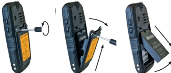
» Løsne skruene i batteriommet med den medfølgende skrutrekkeren.
