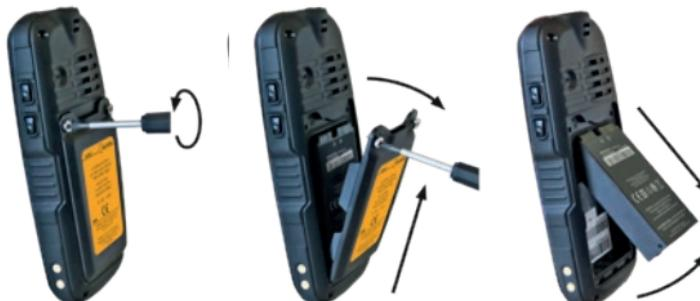
» バッテリーソケットのネジを付属のドライバーでゆるめます。
