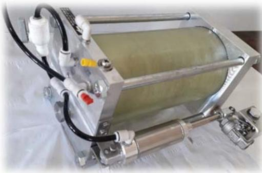
**Un purgeur pneumatique automatique, sans perte de gaz, sans électricité, à chasse rapide**
