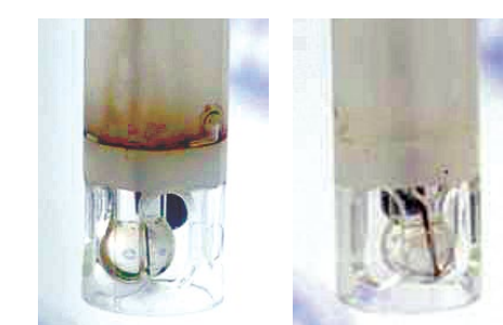
Électrolyte à gel contaminé (gauche) et propre (droite)
