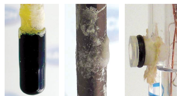
Cristallisation inoffensive sur le capuchon de stockage, l'axe de l'électrode ou l'orifice de remplissage
