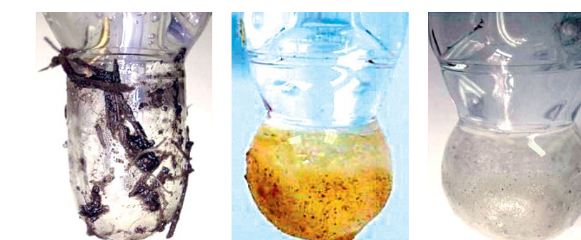
Contamination externe du bulbe en verre
