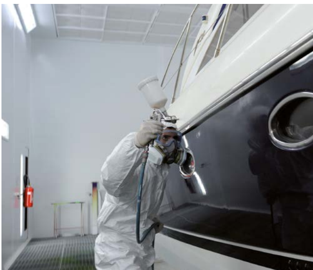
(Appareil de protection respiratoire filtrant avec demi-masque)
